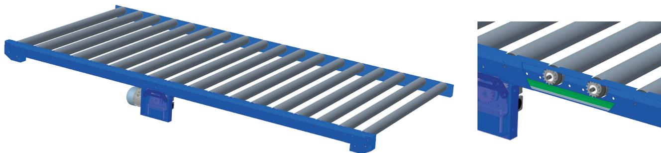
Guter Wirkungsgrad, variable Rollenteilung möglich, höhere Fördergeschwindigkeit möglich, komplexerer Konstruktionsaufbau; Es ist nur ein Zahn vom Kettenrad im Eingriff. Bevorzugt für leichteres Fördergut.
