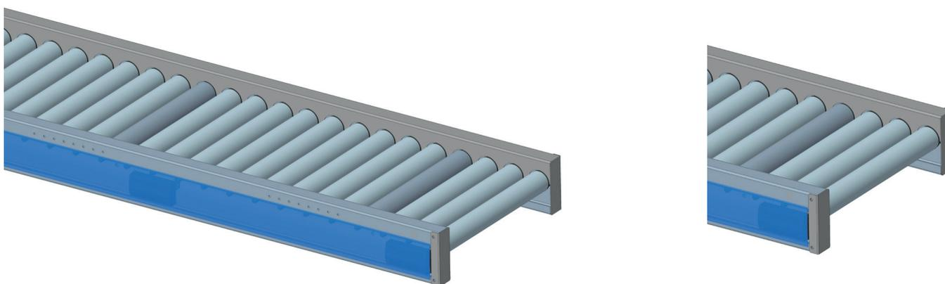
Der im Rohr integrierte Motor ermöglicht eine sehr kompakte Bauweise der Förderanlage. Kurze Förderstrecken mit Stückgutgewicht bis max. 35 kg, vor allem staudrucklose Rollenförderer. Es können Poly-V Riemen oder Zahnriemen zur Kraftübertragung genutzt werden. Es gibt einfache Steuergeräte, die externe Signale einer übergeordneten SPS benötigen, weiters gibt es Zonen-Steuerungen, mit welcher autarke, staudrucklose Förderer aufgebaut werden können.
